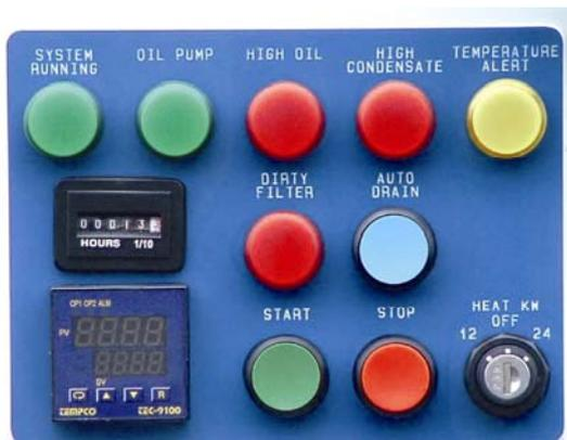
**Quadro di controllo semplificato** - Interuttori semplificati permettono l'avviamento e l'arresto del sistema, il controllo dello scarico del condensato e l'intasamento del filtro particellare.
